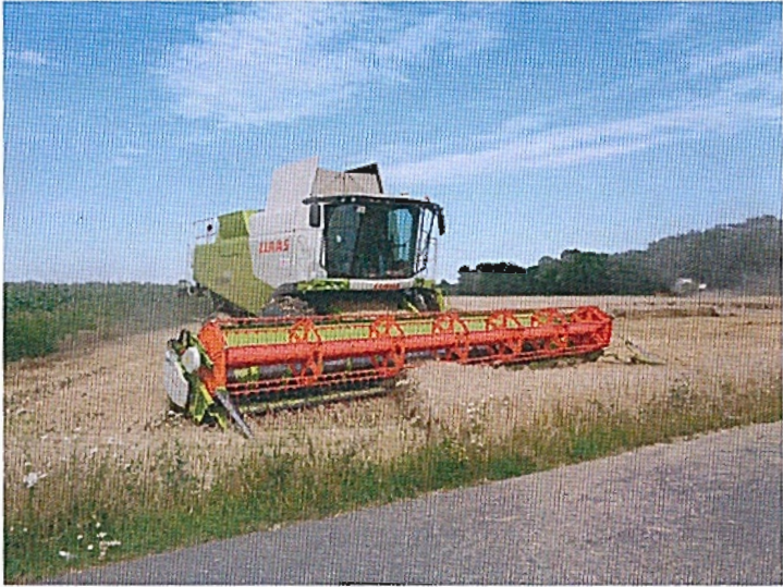
Mähdrescher Typ Claas mit einem Schneidwerk über 10 m.
