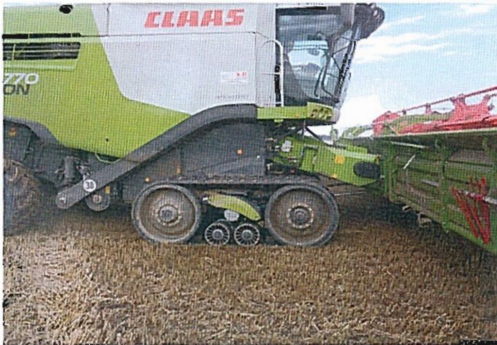
Hier eine neue Antriebsvariante, sehr vorteilhaft bei Bodennässe und verringert die Bodenverdichtung durch diese schweren Maschinen.
